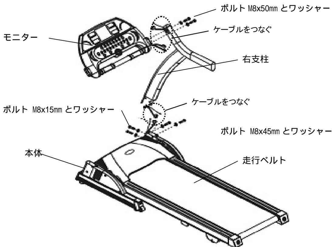
**STEP 2****左柱とモニターの取り付け**
