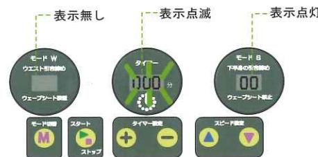
起動状態は、最初モードS(振動板の上に立った状態で使用する)が選択された状態にあります。モードの切替は、「使い方」を参照ください。
