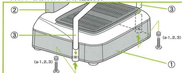
(4) 架台(パート②)に手すり上部(パート④)のもう一方を接続し六角穴付きボルト(b)を六角棒レンチで固定します。
