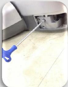
図のように上の2つのボルトは、内側に入っており、下の一つのボルトはプレートと並んで位置するようになる。
