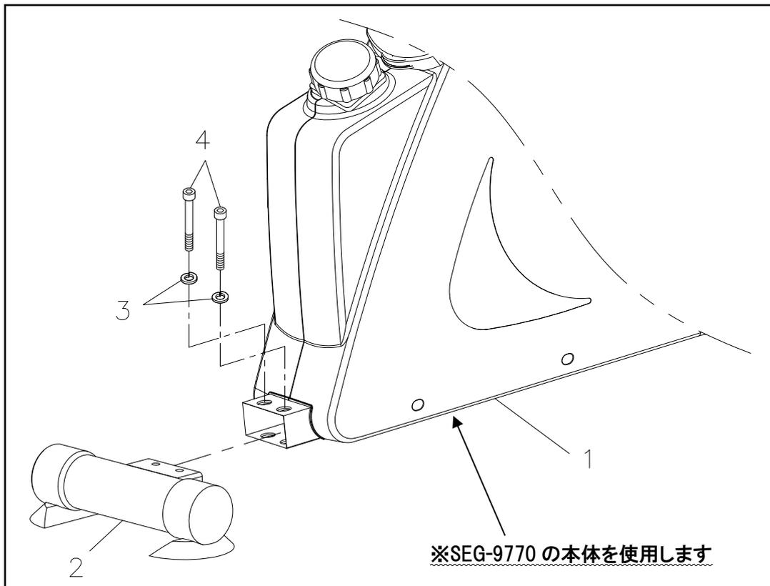
上図を参考に車椅子専用バー(2)を本体フレーム(1)に差込み、ソケットボルト(4)×2本、ロックワッシャー(3)×2枚でL型レンチを使い固定します。
