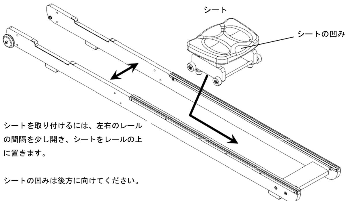
シートを取り付けるには、左右のレールの間隔を少し開き、シートをレールの上に置きます。
